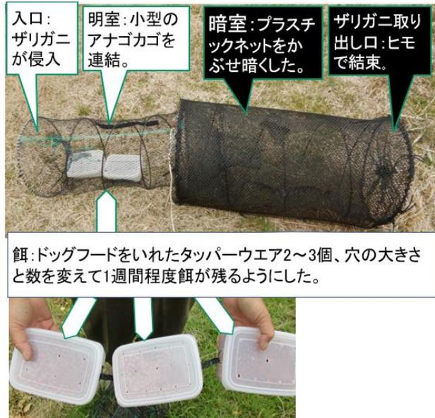
図1 2019年開発の新型連続捕獲装置
