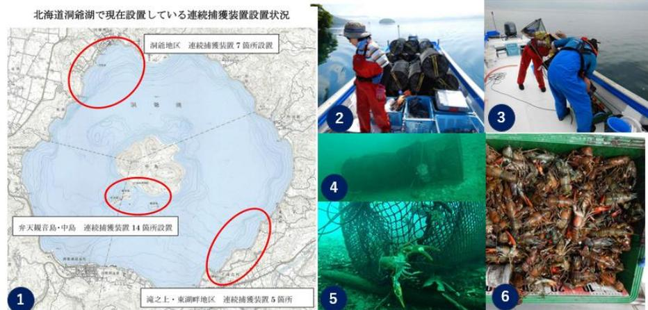
洞爺湖における連続捕獲装置によるウチダザリガニ捕獲実証実験
