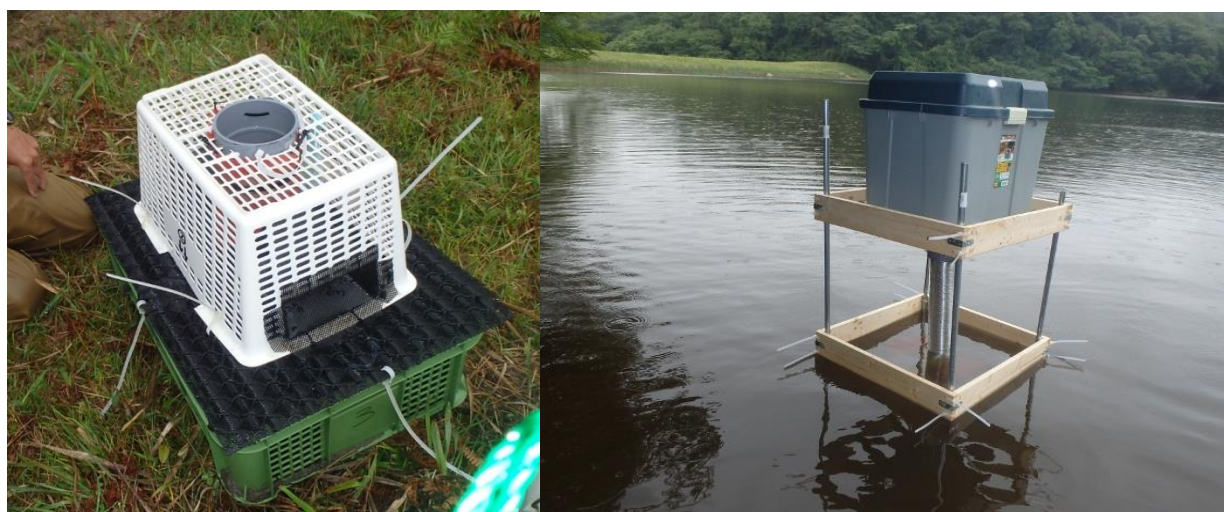
写真 1 左：アメリカザリガニ連続捕獲装置の捕獲器、右：その水上に設置した自動給餌機
