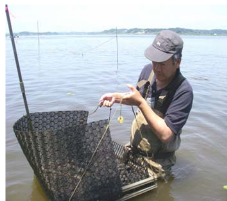
2段式人工産卵床 センサー装着人工産卵床の下段に目合い0.2mmのネットを貼ったトレーを取り付けた。
