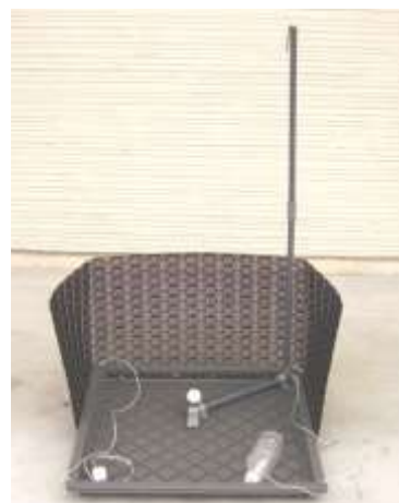
シナイモツゴ郷の会と東北興商が共同で実用化・製品化したセンサー装着人工産卵床
