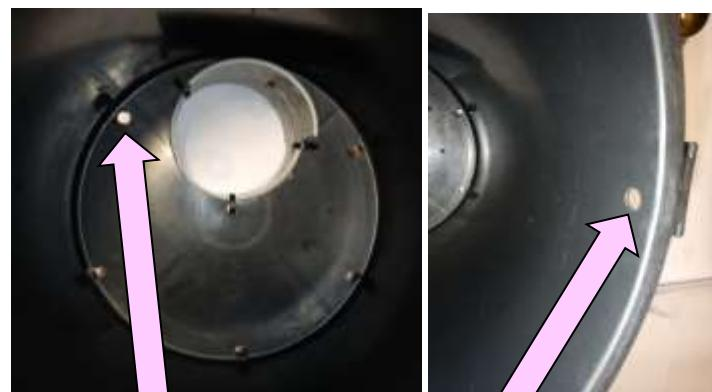
収納バケット内の換気を良くするため、直径10mmの穴を底面に4個、側面に2個開けた。
