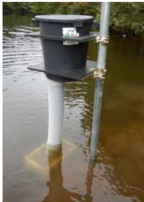
図7 アメリカザリガニ連続捕獲装置 通常トラップの5倍の性能で省力化を実現
