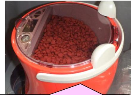
**自動給餌器**: 水上のプラスチック容器内に設置。コイ養殖餌などを使用、投与量と時間をプログラム。
