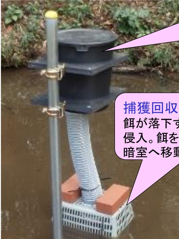
**自動給餌装置**: 水上に架台を設置。自動給餌器を収容するプラスチックと捕獲部へ餌を落とすダクトで構成。
