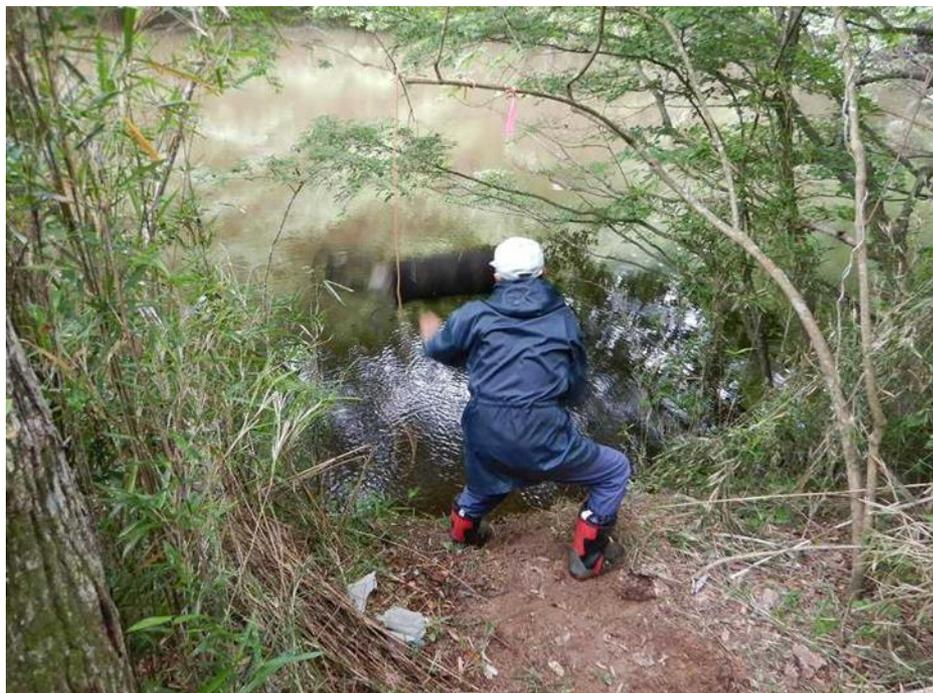
**岸辺から投入**：固定ロープを持って、装置を投げ入れます。投入後、ロープを樹木などへ固定する。
